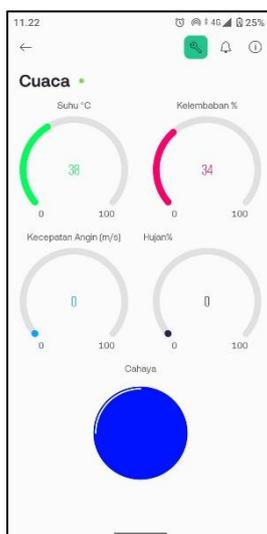
**Gambar 8.** Tampilan Aplikasi Blynk Prototipe Sistem Monitoring Cuaca dan Peringatan Dini Hujan (Sumber Gambar : Dokumen Pribadi)
