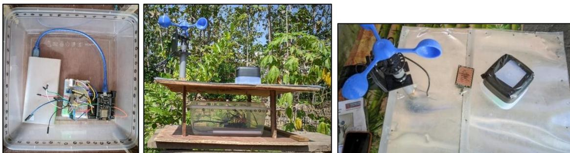
**Gambar 6.** Tampilan Perangkat Keras Prototipe Sistem Monitoring Cuaca dan Peringatan Dini Hujan (Sumber Gambar : Dokumen Pribadi)
