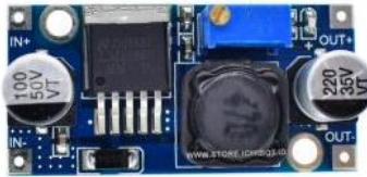
Fig. 6 Step Down LM2596
